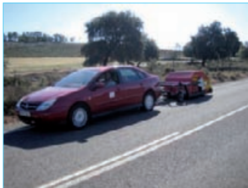
Figura 23. Detalles de los equipos del LA 2 IC utilizados en la auscultación del tramo experimental de la CM-4102: TireSonicMk4-LA 2 IC, LaserDynamicPG-LA 2 IC y láser 2D estático.
