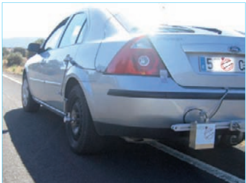
Figura A4. Equipo para la medida del perfil longitudinal de la superficie de la carretera, y su posterior análisis para obtener la MPD.
