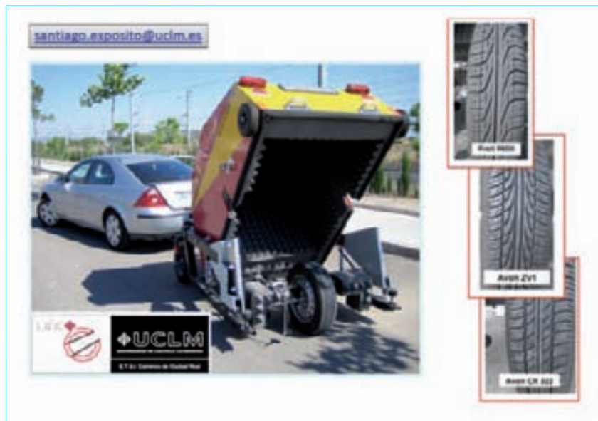
Figura 5. TireSonicMk4-LA 2 IC, mostrando el interior de la cámara con la localización de micrófonos, y neumáticos de referencia (9) .
