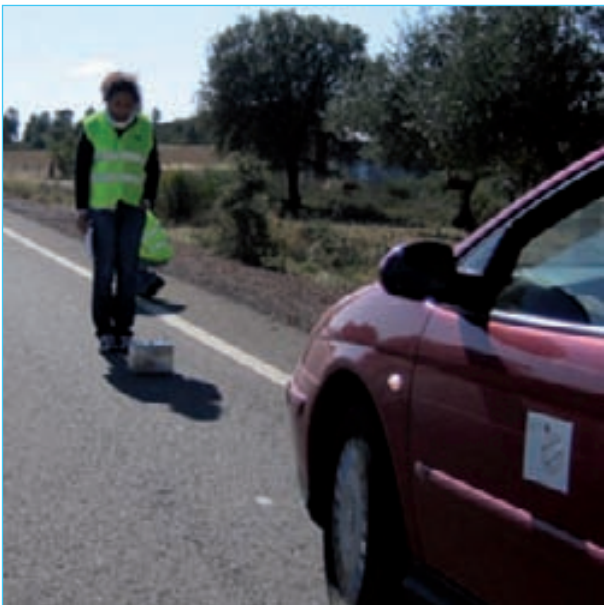
Figura 16. Detalle durante un registro del perfil de la vía en 2D de forma estática para el cálculo de la textura.
