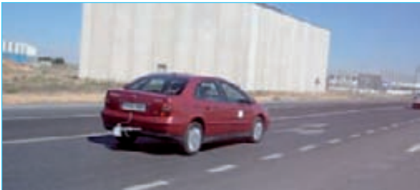
Figura 38. Láser montado en un vehículo del LA 2 IC durante el registro del perfil de la carretera.
