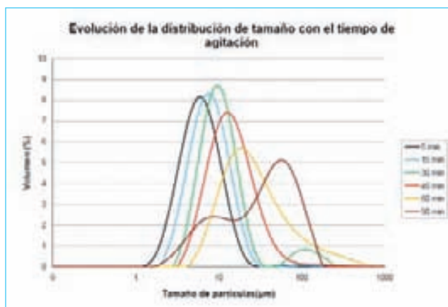
Gráfico 4. Evolución de la distribución del tamaño medio de partícula en función del tiempo de agitación.
