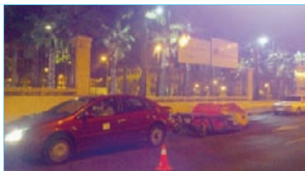
Figura 49. TireSonicMk4-LA 2 IC durante la auscultación acústica del tramo experimental con la mezcla xSMA8 con polvo de caucho procedente de NFU, a los 5 meses de la puesta en servicio.
