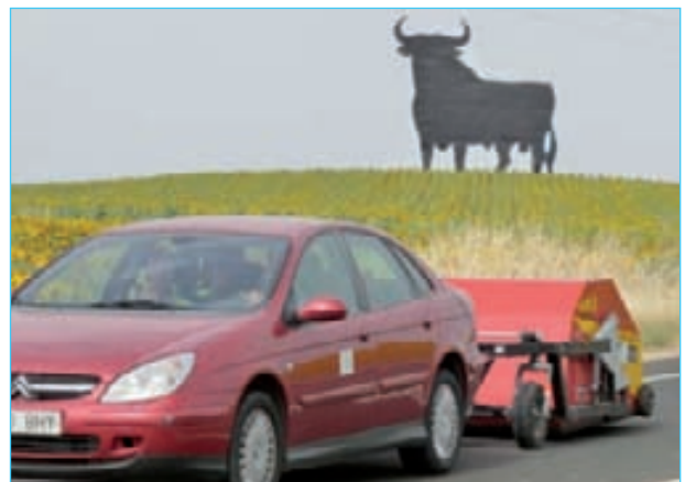
Figura 30. Equipo de auscultación acústica durante un ensayo en la A-472 en Sevilla.
