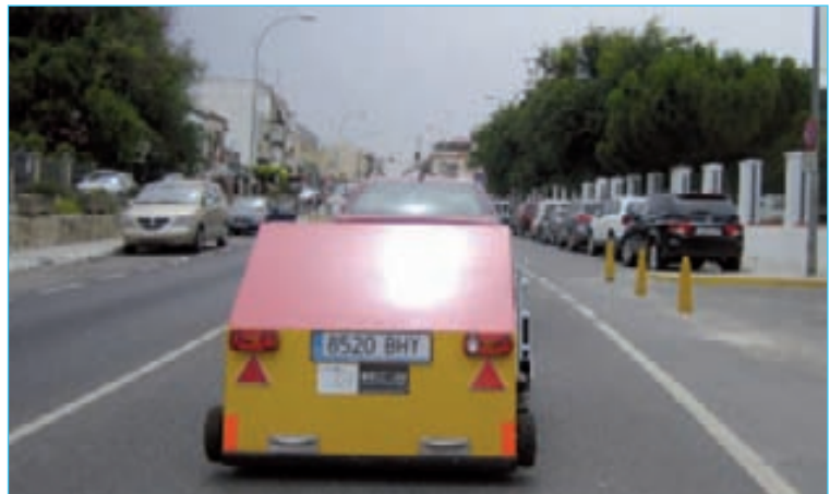
Figura A1. Remolque TiresonicMk4-LA 2IC durante un ensayo para la caracterización acústica de una mezcla bituminosa en servicio.
