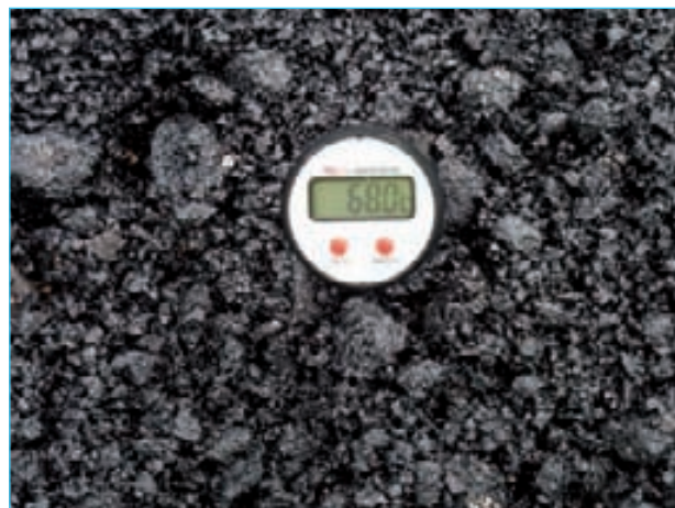
Figuras 6 y 7. Proceso de emulsificación del betún con la humedad de las arenas (fuente EIFFAGE).
