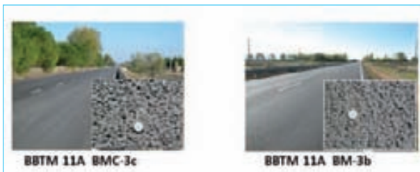
Figura 17. Detalle de los tramos experimentales y de la textura de las mezclas BBTM 11A con y sin polvo de caucho NFU.
