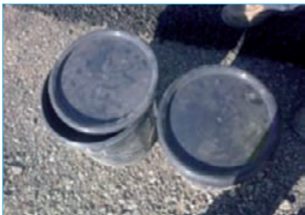
Figura 4. Recipientes para el almacenamiento y acondicionamiento de las muestras de mezclas templadas tomadas en obra para su posterior control de calidad.
