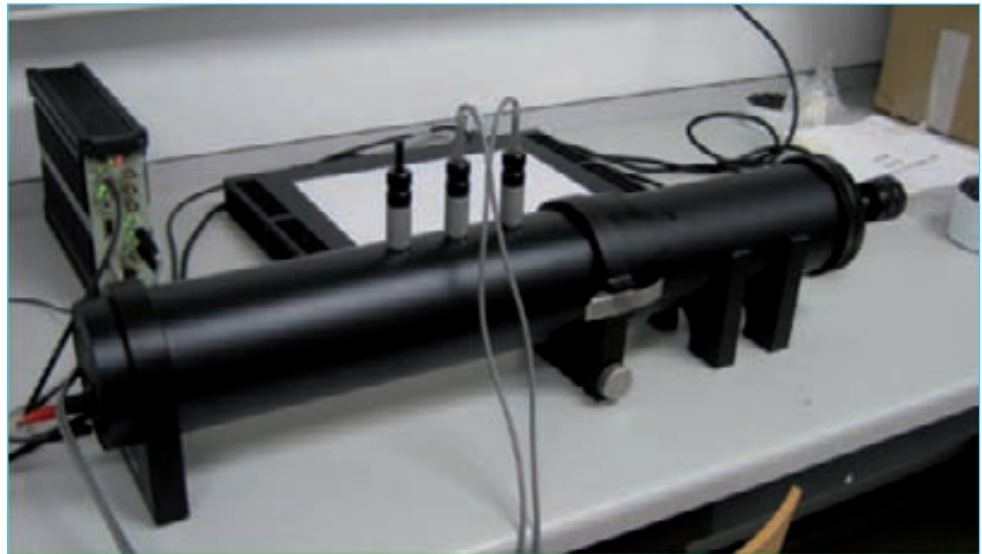
Figura A3. Tubo de impedancia utilizado para la medida de la absorción acústica entre 50 Hz y 1600 Hz de una probeta de mezcla bituminosas.
