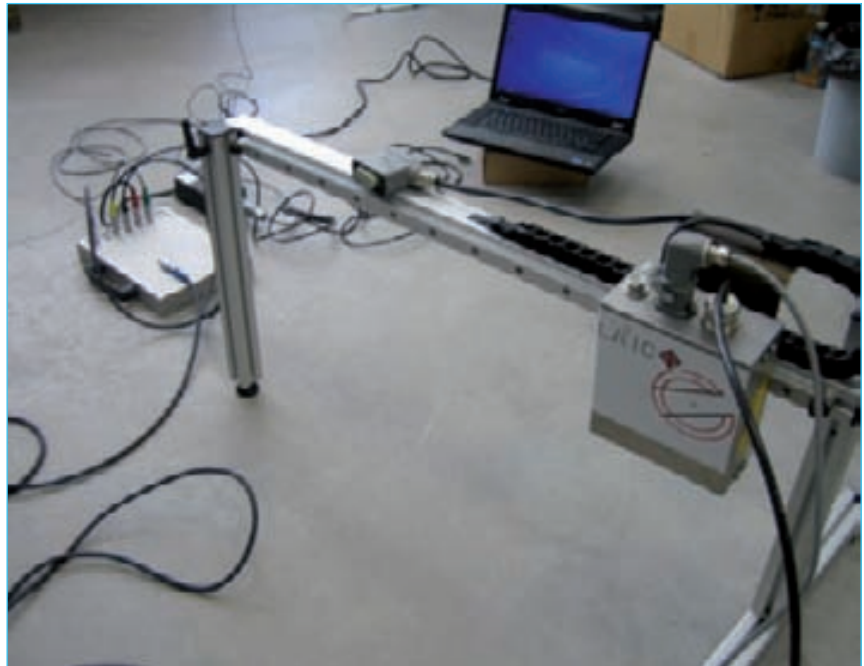
Figura A5. Equipo para la medida del perfil y obtención del espectro de la textura.
