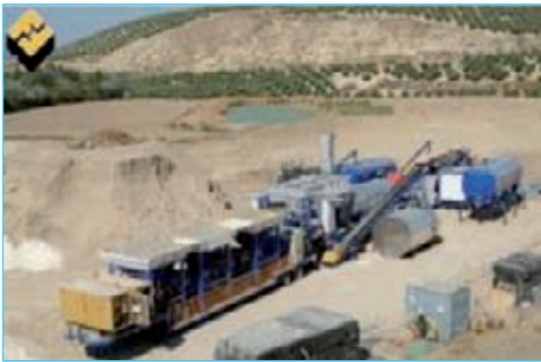
Figura 1. Planta móvil adaptada para la fabricación de mezclas templadas con emulsión.
