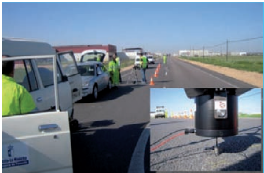
Figura A6. Excitador y cabeza de impedancia para la medida de la rigidez dinámica de la capa de rodadura in situ.
