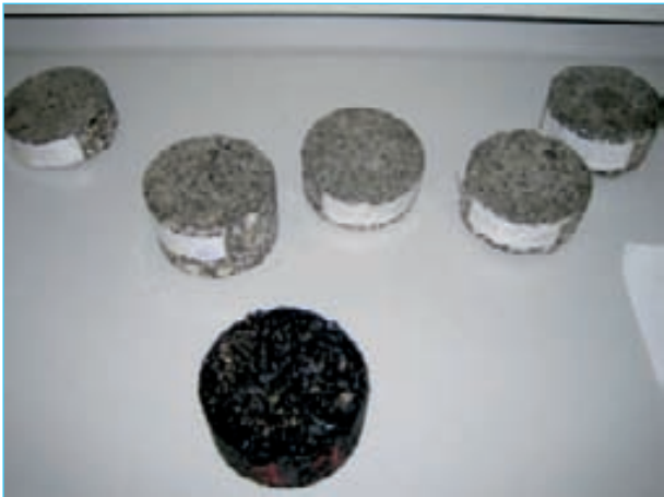
Figura 26. Testigos extraídos y probetas fabricados para la medida de la absorción sonora de Lechadas Bituminosas.
