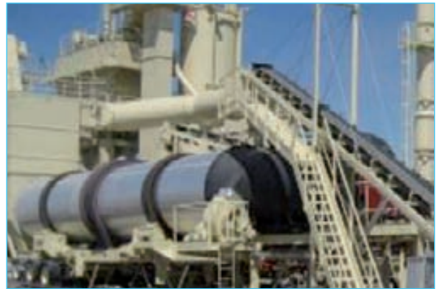
Figura 2. Planta de fabricación de mezclas recicladas con tambor secador de flujo paralelo y anillos para la introducción del MRMB.
