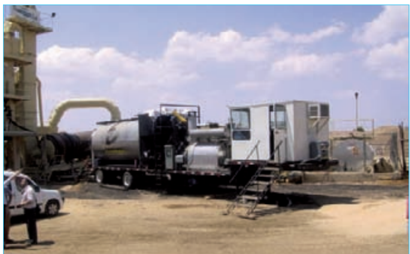
Figura 1. Equipo de fabricación in situ de betún con caucho.
