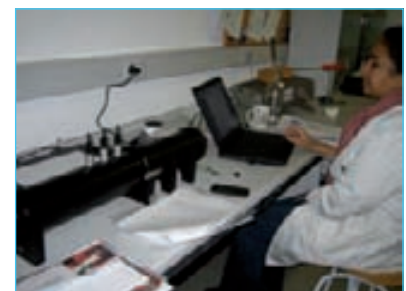
Figura 40. Trabajos de compactación de la mezcla BBTM 11A BMAVC y de medida de la absorción sonora en tubo de impedancia.
