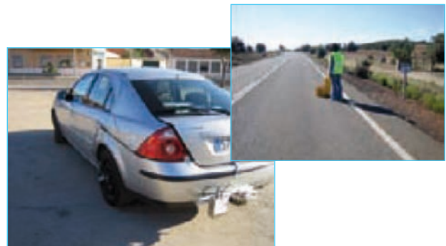
Figura 23. Detalles de los equipos del LA 2 IC utilizados en la auscultación del tramo experimental de la CM-4102: TireSonicMk4-LA 2 IC, LaserDynamicPG-LA 2 IC y láser 2D estático.
